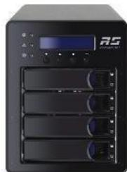
RocketStor 6540S (RS6540S)是一个4盘位NVMe U.2 JBOD盘箱，设计用于SSD7184。4个可移动驱动器托架中的每一个都支持一个U.2的NVMe SSD。
