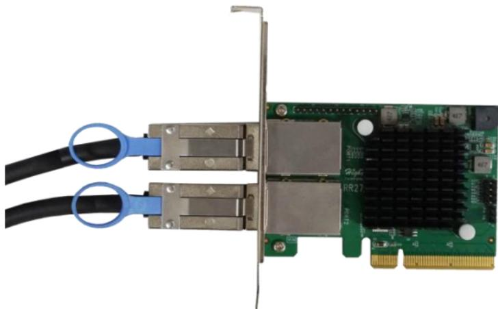
SFF-8088转SFF-8088的另一端连接至RS6418S SFF-8088连接器, 如下图所示 (a至a, b至b), RS6418S连接至SAS/SATA硬盘驱动器或SSD, 并连接至交流电源;
