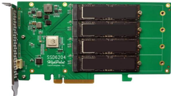
**注意:** 确保SSD小心但牢固地安装到每个M.2端口中。连接松动可能会导致各种稳定性和性能问题，并可能最终导致数据丢失。
