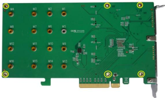
拆卸螺钉后，小心地从SSD6204上拆卸散热器。
