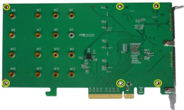
**注意：**在将铝盖重新紧固到SSD6204之前，请确保铝盖与控制器板(PCB)正确对准，并与热垫完全接触。如果盖子安装不当，热垫将无法充分冷却NVMeSSD和控制器组件，这可能导致SSD或控制器硬件损坏、性能损失、不稳定的I/O和数据丢失。
