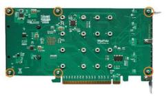
拆下螺钉后,小心地从SSD7101A-1上拆下前面板。
