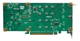
注意: 在将铝盖重新固定到SSD7101A-1上之前,确保铝盖与 控制器板(PCB)正确对齐,并与散热垫完全接触。如果盖 子安装不当,风扇和散热垫将无法充分冷却NVMe SSD和控 制器组件,这可能会导致SSD或控制器硬件损坏、性能损 失、I/O不稳定和数据丢失。
