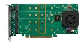
步骤 4. SSD应该从上到下安装。拆下顶部螺钉。
