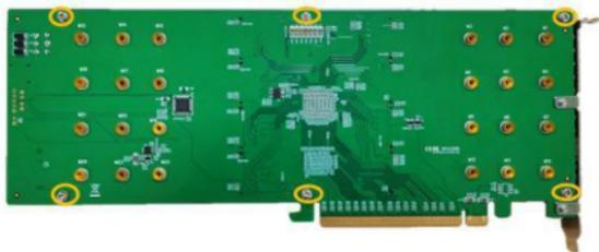
**注意：** 在将铝盖重新固定到SSD7140A之前，确保铝盖与控制器板（PCB）正确对齐，并与散热垫完全接触。如果安装不当，风扇和散热垫将无法充分冷却NVMe SSD和控制器组件，这可能会导致SSD或控制器硬件损坏、性能损失、输入/输出不稳定和数据丢失
