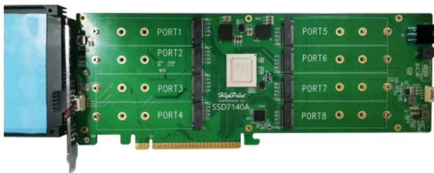
步骤 3. 拆下外壳后，小心地将其翻转以查看隔热垫。重新安装面板之前，必须先从衬垫上撕下蓝色薄膜。这些贴膜在安装前保护焊盘免受损坏和异物，但是，如果我们不将其移除，它们也会阻止热焊盘将热量从NVMe SSD传导出去。
