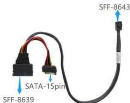
2. 上图所示的是一根SFF-8643至U.2SFF-8639电缆，带有15针SATA电源连接器。SFF-8639端口应连接到NVMeSSD的U.2端口。15针SATA电源连接器应连接到系
