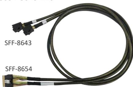
SFF-8654 (主机) 转 SFF-8643 (设备) PCIe 4.0 x8 NVMe电缆。每根电缆最多可容纳2个NVMe SSD。
