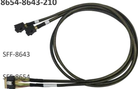
SFF-8654 (主机)转 SFF-8643 (设备) PCIe 4.0 x8 NVMe 电缆。每根电缆最多可容纳2个NVMe SSD。
